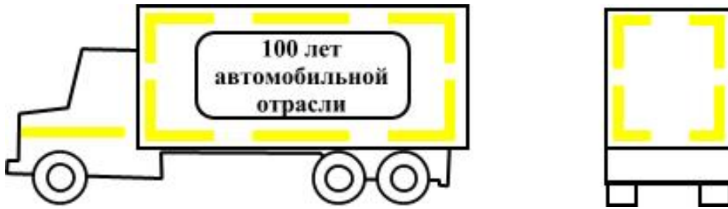
Рисунок А.11 – Контурная маркировка прерывистыми полосами автотранспортного средства с отличительной и/или графической маркировкой
